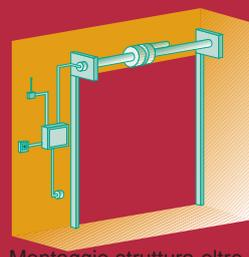
Montaggio struttura oltre luce con montante dx o sx in luce
