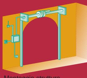
Montaggio struttura oltre luce a forma di arco
