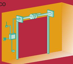
Montaggio struttura oltre luce
