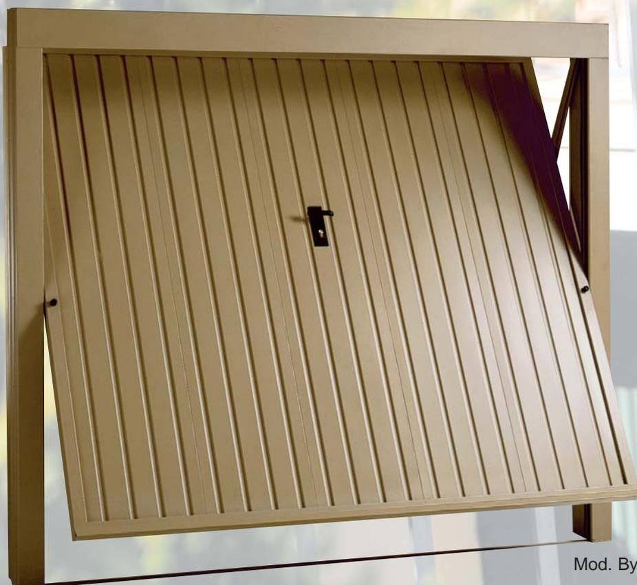
Porte basculanti a telo unico "mod. Byron" costruite su misura interamente realizzate in acciaio zincato e verniciato a mano di fondo colore "sabbia" RAL 1019 di serie. Funzionamento a contrappesi, contro telaio autoportante con guarnizioni in PVC. Serratura con cilindro intercambiabile e sbocco interno per l'apertura senza uso della chiave. A richiesta motorizzata.
