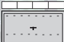
Porta Basculante con sopraluce fisso oltre telaio porta
