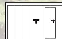
Porta Basculante con porta pedonale applicabile a Dx e realizzabile solo da mt. 2,60 largh. esterno telaio in su (Automazione Elettrokrit 2)
