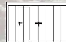
Porta Basculante con porta pedonale applicabile a Sx e realizzabile solo da mt. 2,60 largh. esterno telaio in su (Automazione Elettrokrit 2)
